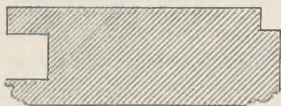
Rys. 4. Przecięcie poprzeczne słupca drzwi lub okna.
