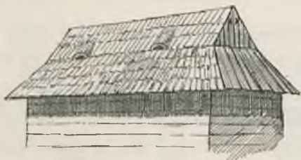
Rys. 15. Dach z dymnikami.
