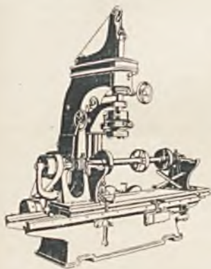
Fig. 11. Szlifierka do walcy wkłesłodrukowych firmy Kempewerk
