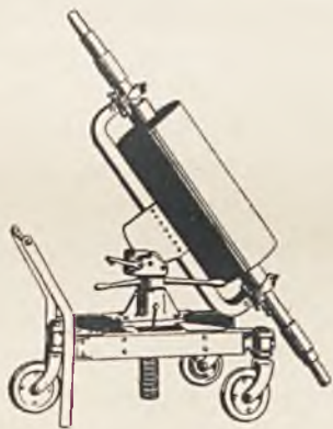
Fig. 12. Wózek do walcy dla maszyny rolowej
