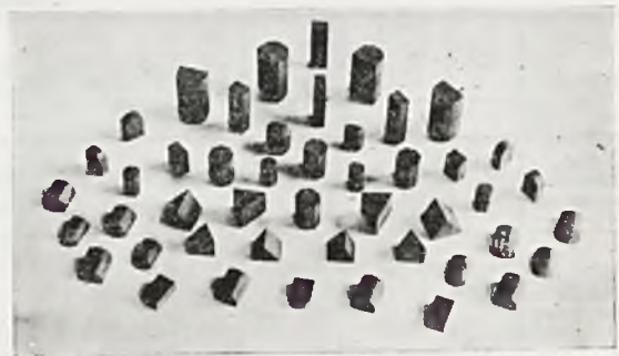
Rys. 3. Kształtki geometryczne różnego typu z węglków spiekanych
