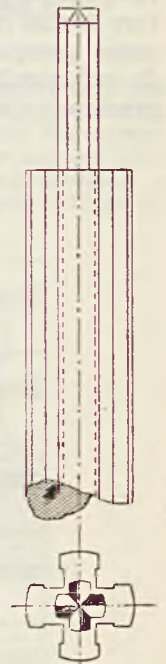
Rys. 2. 6" krzyżak-przewodnik z wykutym u spodu 2" świdrem-krzyżakiem
