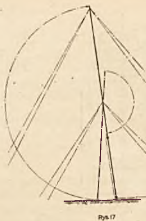
Rys. 15 — 17. Maszt przewoźny K 113 R. Stawianie maszlu
