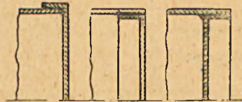
Rys. 141. Włutowywanie denek do naczyń blaszanych
