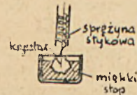
Rys. 122. Kryształ detektorowy osadzony w miękkim stopie
