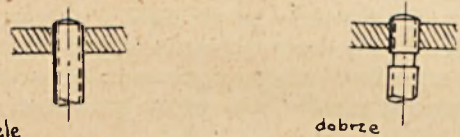
Rys. 145. Lutowanie trzpienia gwintowanego
