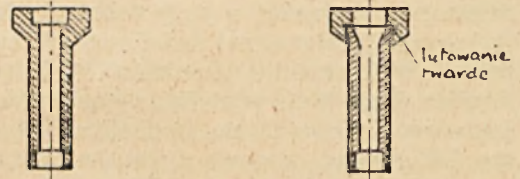
Rys. 144. Wykonanie stalowej śruby specjalnej
