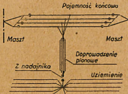
Rys. 16a. Antena typu A z uziemieniem.
