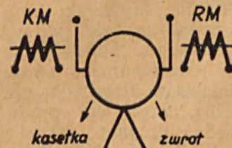
Rys. 4. Elektromagnesy kierujące monetę do kasetki lub do zwrotu.
