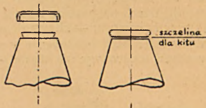
Rys. 93. Uszczelnienie saterowanej pokrywki przy pomocy lakieru.
