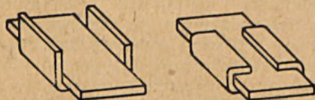
Rys. 42. Połączenie zaginаными łapkami; wzajemne położenie detali jest wynikiem naprężeń w zagiętych łapkach.
