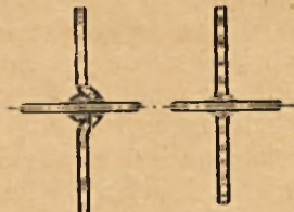
Rys. 85. Zatopienie perełkowe drutu w szkłe.
