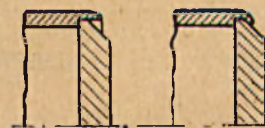
Rys. 69. Podtoczenie grubościennej rury celem zasaterowania szybki szklanej.
