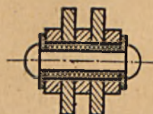
Rys. 13. Połączenie nitowane izolowanych krążków kontaktowych.
