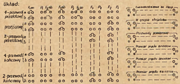
Rys. 11. Rozmieszczenie gniazd w tablicy obsługi wzmacniaka uniwersalnego I.
