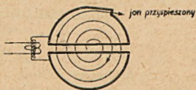
Rys. 11. Cyklotron — przyrząd do przyspieszania jonów.
