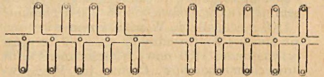
Rys. 8. Końcówki lutownicze, tłoczone z blachy mosiężnej.
