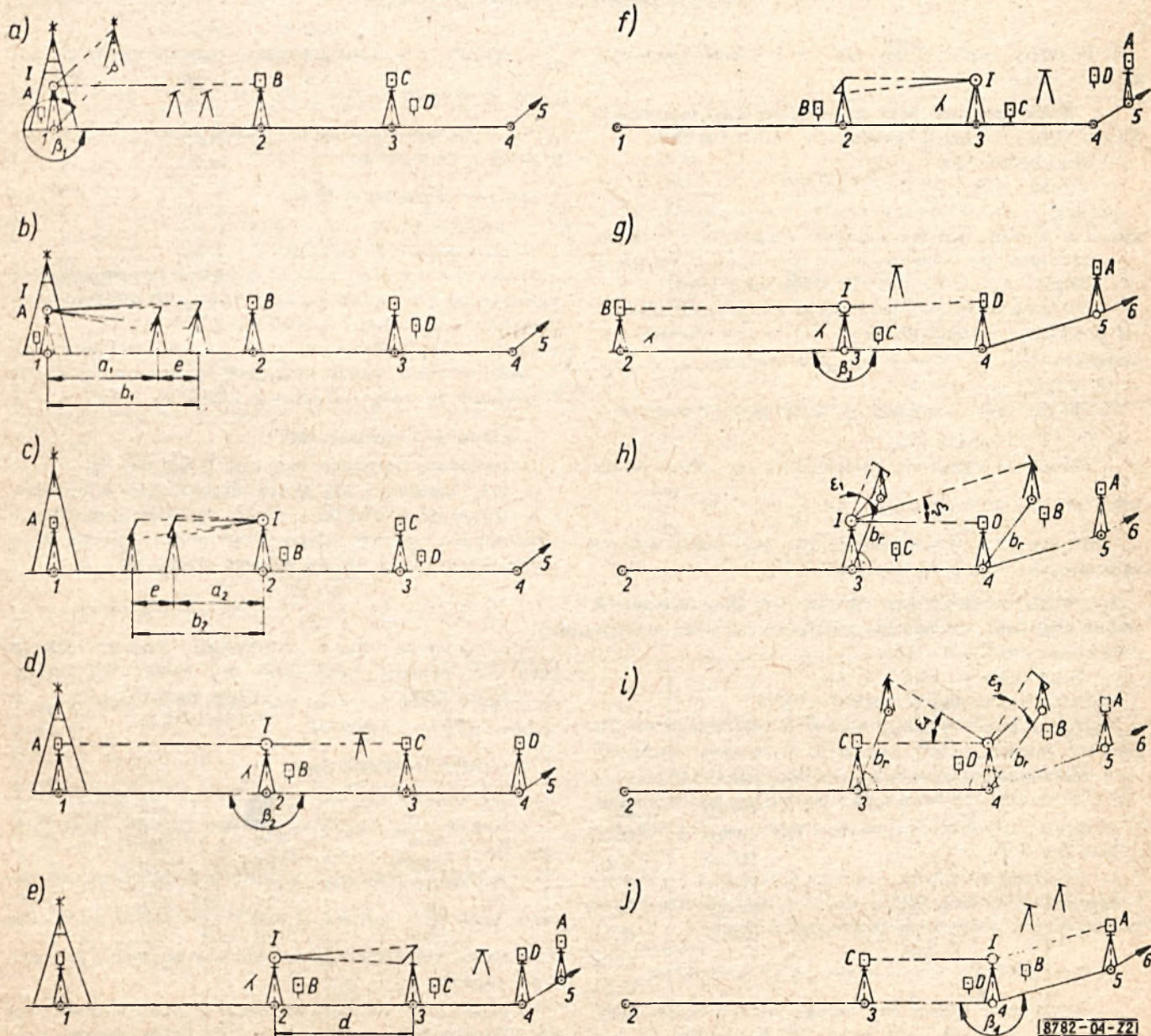
Rys. Z2. Schemat graficzny organizacji pomiaru długości metodą paralaktyczną i kątów załamania ciągu metodą trzech statywów
