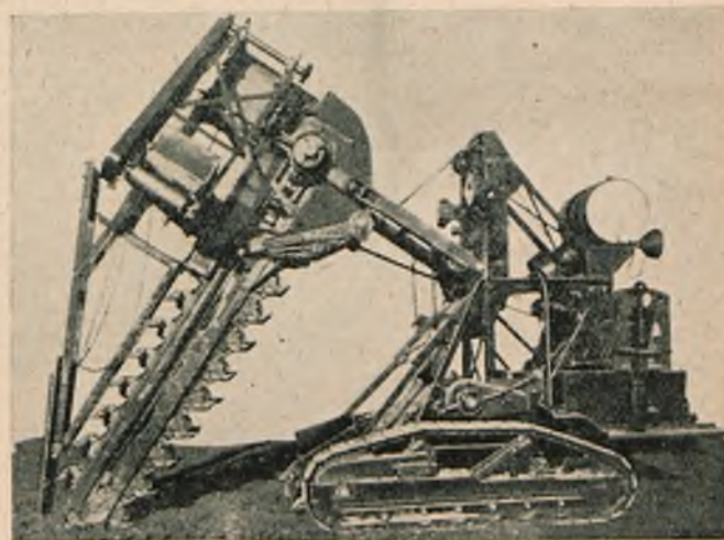
Rys. 5. Kopaczka do rowów, „drabiniasta”, model 44 C, fabrykat Barber Greene Co.
