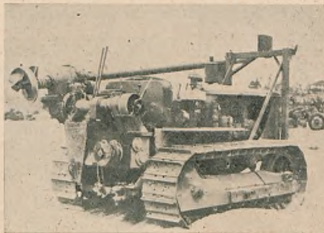
Rys. 4. Świder do ziemi, zmontowany na ciągniku na podwoziu gąsienicowym w pozycji do przewozu.
