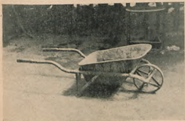
Fig. 1. Głębokie taczki żelazne do betonu i zapraw. Pudełko taczki wpuszczone pomiędzy policzki uchwyty.
