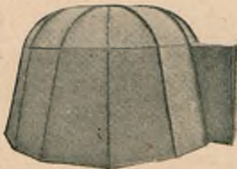
Rys. 25. Schron blaszany — widok.
