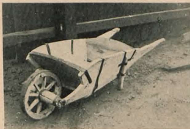
Fig. 4. Taczki drewniane średniej pojemności ok. 80 l do robót ziemnych.
