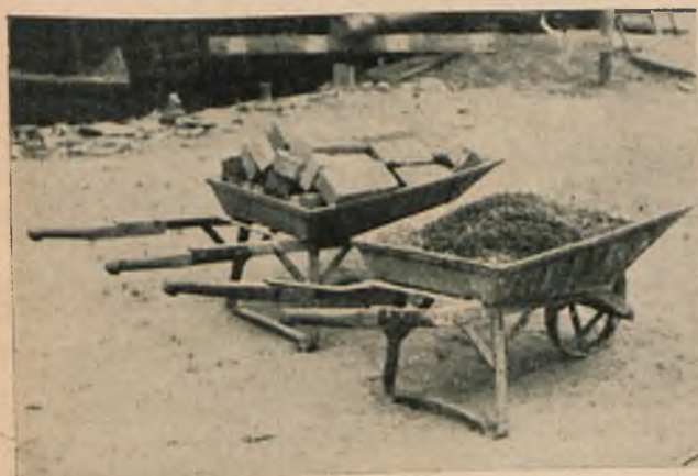
Fig. 2. Taczki żelazne o pudle płaskim umieszczonym na podwoziu. Na pierwszym planie taczki do betonów i zapraw z wygiętymi ku górze uchwyty w celu zmniejszenia podniesienia opórek taczki. — Zdjęcie z jednej z budowli firmy „Bud. K. Przybyła i bud. K. Jastrzembki — Katowice i Tarnowskie Góry.
