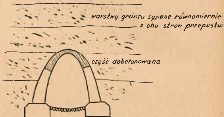
Rys. 3. Przepust z rys. 1. po przeprowadzeniu naprawy.
