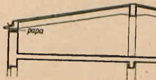
Rys. 22. Dach oparty na ścianie zewn. strychu.
