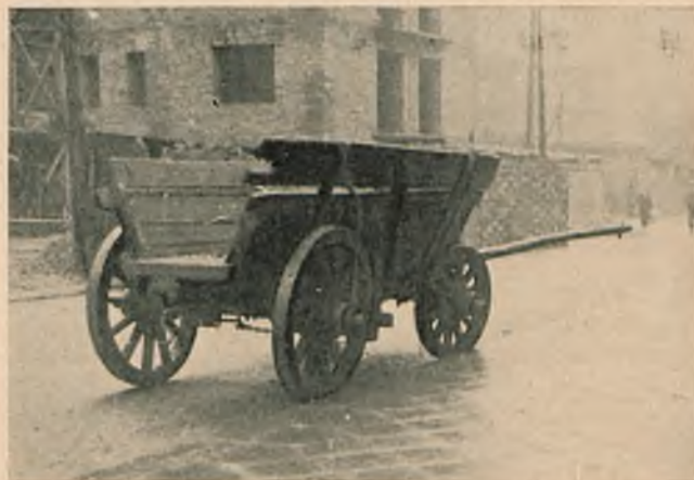
Rys. 1. Ciężki wóz do przewozu materiałów budowlanych stoi na zwolnionym hamulcu na dużym spadku.
