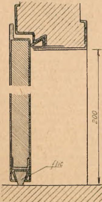
Rys. 15. Drzwi z blachy z izolacją przeciwdźwiękową.
