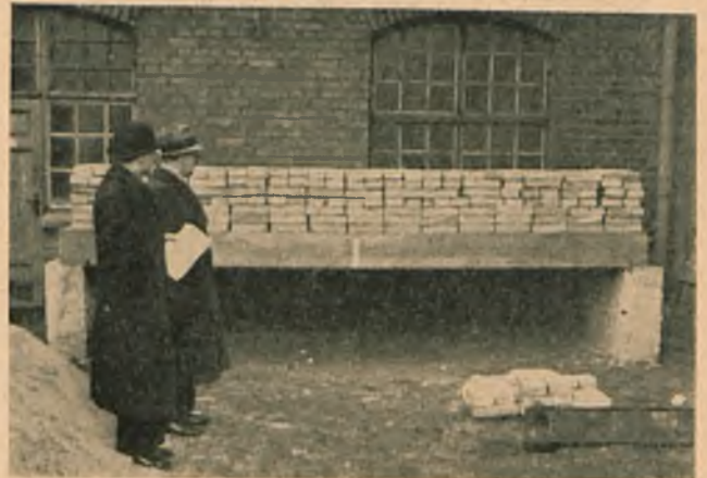
Rys. 5. Ciężar własny i użytkowy ok. 3200 kg. Ugięcie 1 mm.
