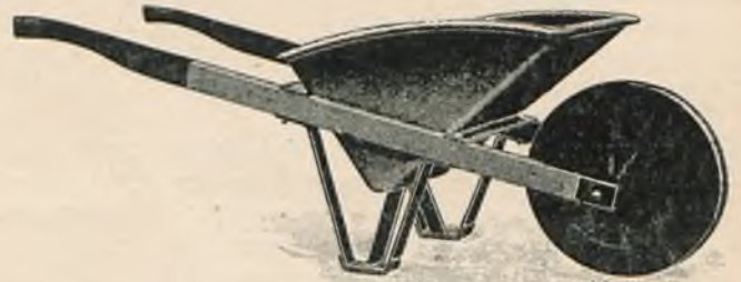
Rys. 4. „Perfecta”. Kolo zmontowane z dwóch kręgów wytłaczanych; nóżki związane z pudłem; pudło żelazne spawane elektrycznie bez żadnych występów od wewnątrz, dyszle z drzewa jesionowego.
