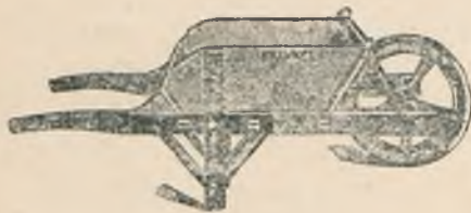
Rys. 1. Francuski typ taczki dla robót ziemnych. Średnica kola = 0,45 \text{ m} .
