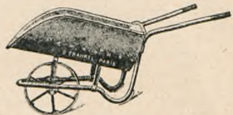
Rys. 6. Taczka-łopata dla odlewni, kuźni hutniczych, fabryk chemicznych itp.
