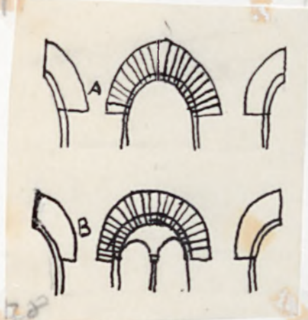
Rys 28 A-ostrołukowe przesklepienie okien,
