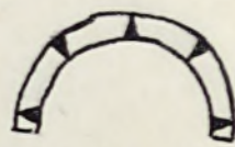
Rys 19 Układ pęknięć na łuku
