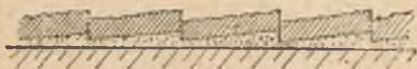
Rys. 24. Układ płyt okładzinowych z piaskowca łupanego na elewacjach podwórzy III i IV (skala skażona).
