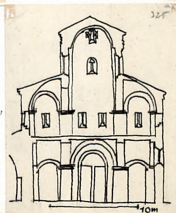
Rys-375-Przekrój poprzeczny przez narteks w Tournus.
