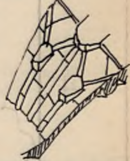
Konstrukcja żeber w tej kaplicy
