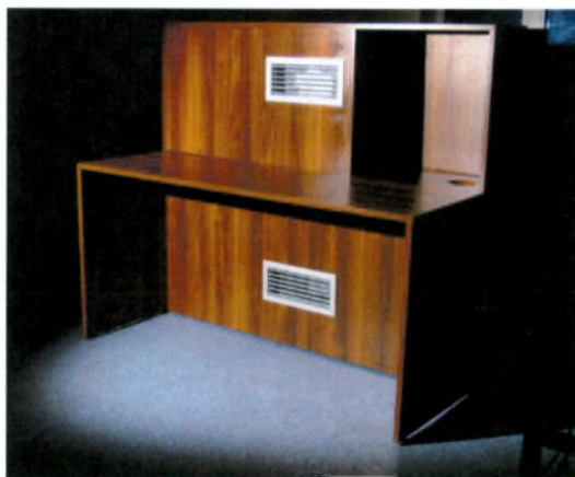
Rys.5.1. Skonstruowane na potrzeby badań biurko ze zintegrowaną instalacją wentylacji indywidualnej.
