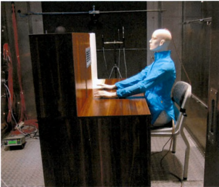
Rys.5.4. Stanowisko do badań z udziałem ochotników i manekina termicznego umieszczone w komorze klimatycznej.
