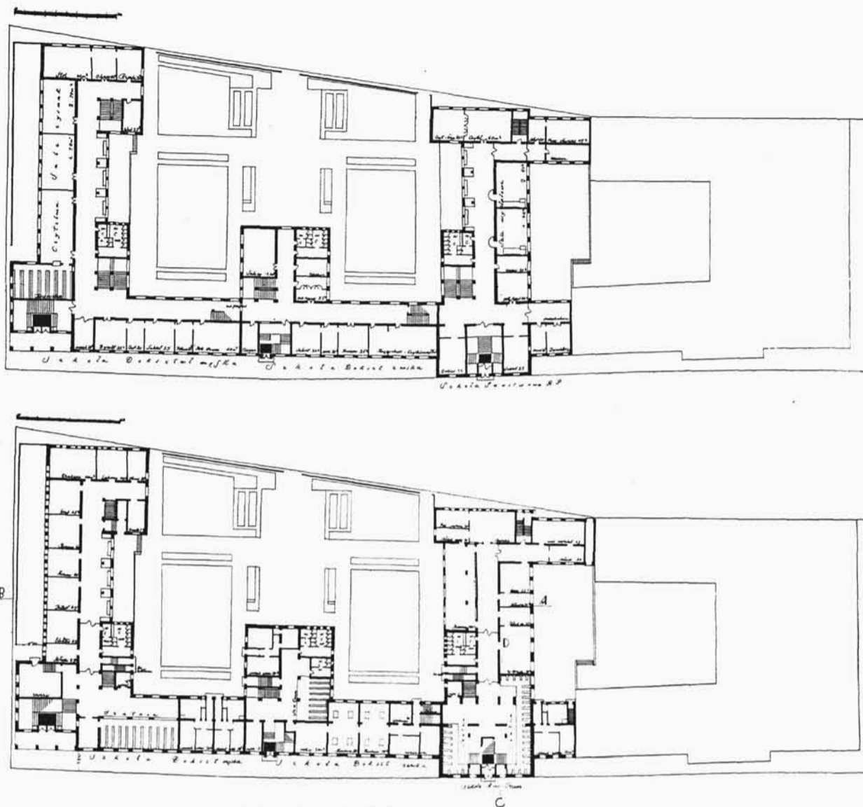
ARCH.: JADWIGA DOBRZYŃSKA I ZYGMUNT ŁOBODA (WARSZAWA). PROJEKT KONKURSOWY № 34 SZKÓŁ: RZEMIEŚLNICZO-PRZEMYSŁOWEJ I DOKSZTAŁCAJĄCEJ W POZNANIU. NAGRODA I. Rzutny parteru (u góry) i podziemia (u dołu).
