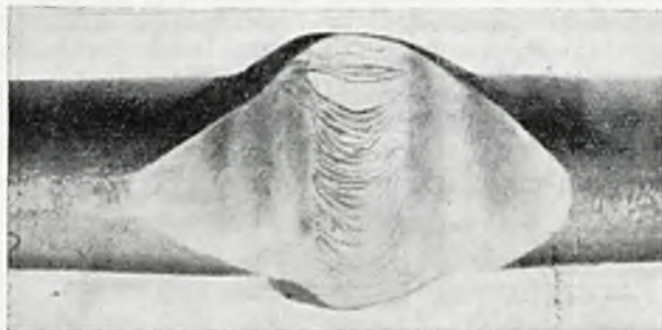
Rys. 4. Makrografia spoiny na I. wykonanej metodą „Secrom”.
