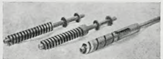
Rys. 85. Śruby napędowe grzebieni z rys. 83. Dwie śruby o małej szybkości ruchu — dla wyciągania włókien; śruba o dużej szybkości — dla powrotnego ruchu grzebieni.
