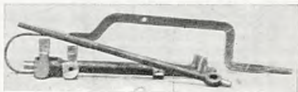
Rys. 89. Różne części krosna tkackiego (od góry do dołu): 1. Dźwignia sprzęgłowa napawana po uszkodzeniu stalą Tostic. 2. Oś napędowa napawana stalą Tostic. 3. Oś napędowa; czopy osi napawane stalą Tostic. 4. Popychacze (dwie drobne części na lewo) napawane Alchromem.
