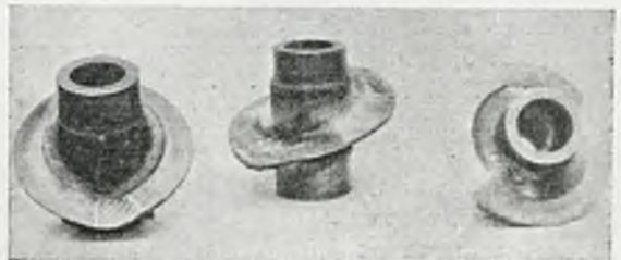
Rys. 75. Części przepustki cewiarki napawane żeliwem.
