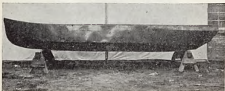
Łódź długości 5 m 50 i szerok. 1 m 50 wykonana całkowicie ze stali spawanej.
