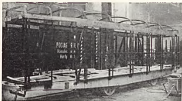
Próbny wóz tramwajowy o szkieletcie spawanym. wyrobu f. Lilpop, Rau i Loewenstein w Warszawie.
