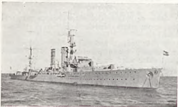
Rys. 8. Pierwszy powojenny krążownik niemiecki „Emden” z 1923 r. częściowo spawany, dał początek nadzwyczajnemu rozwojowi spawania w budowie marynarki wojennej Niemiec oraz innych krajów.
