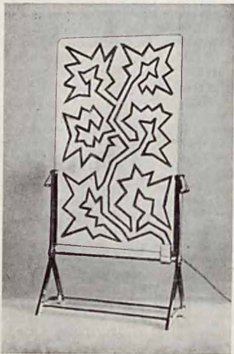
Rys. 2. Ekran grzejny o długości paska oporowego 8,2 m. Moc prądu — 700 W, temp. : 120 — 150°.
