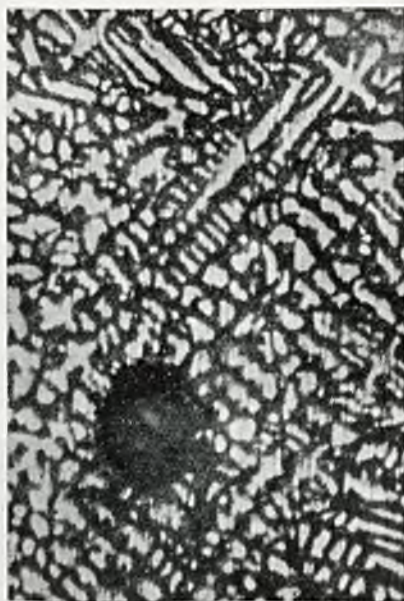
Rys. 5. Niewielki nadmiar tlenu, struktura spoiny grubokryształiczna z pojedynczymi porami.
