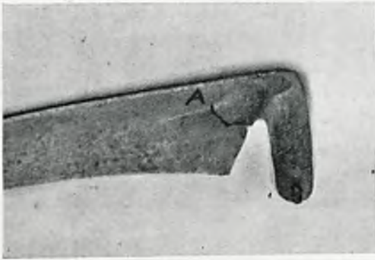
Rys. 2. A — początek spawania. Typowe pęknięcie.
