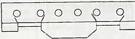
Rys. 24. Przykład pęknięcia łubka.
