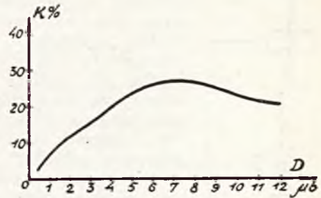
RYŚ. 3. ZNIEKSZTAŁCENIA NIELINIOWE MIKROFONU TELEFONICZNEGO.
