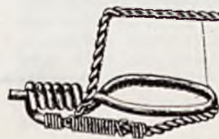
RYS. 2. ZŁĄCZENIE PRZEWODU LINJOWEGO Z DRUTEM 2 MM. BRĄZOWYM ODŻARZ. I ZE ZŁĄCZKĄ PROBIERCZĄ.
