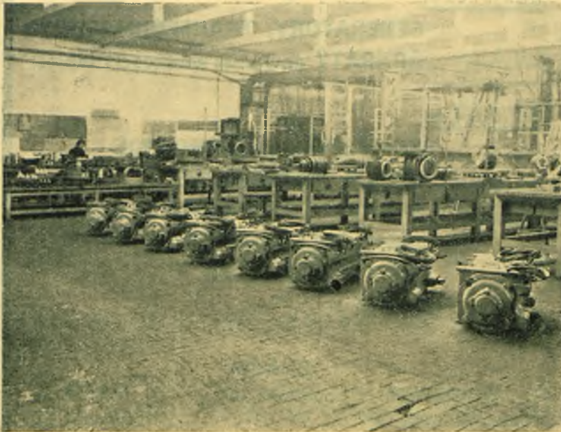
Pierwsza partja silników tramwajowych o mocy godzinnej 42 KM, 660 obr/min, 550 Volt produkcji fabryki Warszawskiej — dla Dyrekcji Warszawskich Tramwajów
