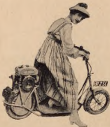
Rys. 13. Skuter marki „Scotamota“ silnik dwutaktowy 1\frac{1}{2} KP, cylinder stalowy.
