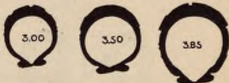
Rys. 168. Porównanie przekroju pneumatyków wysoko-, średnio i niskociśnieniowych. Jak widzimy przy tej samej średnicy zewnętrznej koła, obręcz staje się coraz mniejszą.
