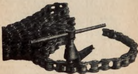
Rys. 137. Sposób wyprasowywania sworznia z ogniwa łańcuchowego.
