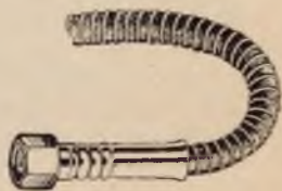
Rys. 60. Giętka rurka do przewodów benzyny i oliwy. Rurki takie są praktyczniejsze od zwyczajnych miedzianych, gdyż nie tak łatwo pękają.
