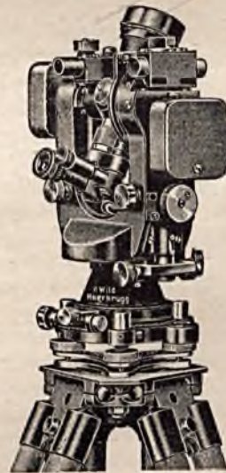
Teodolit z oświetleniem elektrycznym i dodatkowym pryzmatem, załamującym celowe pod kątem prostym.
