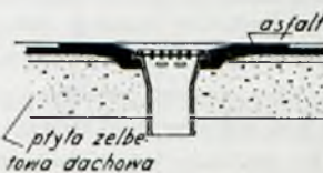
Rys. 7. Uszczelnienie rury odpływowej.
