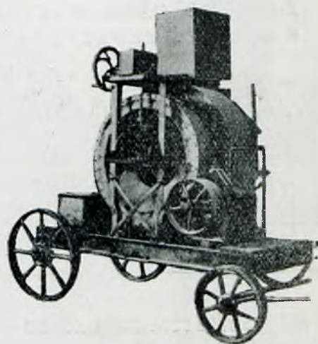
Betoniarka Ransome 250 l.
