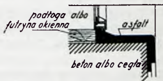
Rys. 4. Uszczelnienie połączenia z oknem stalowym albo drzwiami.
