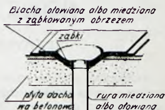
Rys. 6. Uszczelnienie rury odpływowej.
