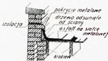
Rys. 11. Połączenie dachu drewnianego z murem.
