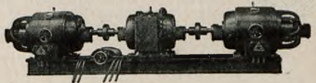
Rys. 15. Podwójny zespół elektryczny do celów spawania z przełącznikiem walcowym dla włączania pojedynczo lub równoległe.
