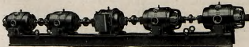
Rys. 16. Poczwórny zespół elektryczny do celów spawania z silnikiem o wirniku zwartym.
