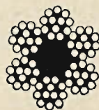
Rys. 34. Przekrój liny ciągnącej.
