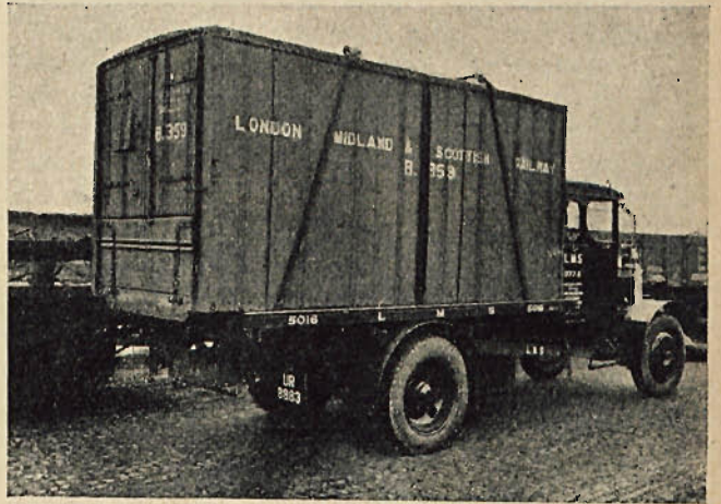
Rys. 2. Kontener stalowy ładowności 4 t kolei angielskiej L. M. S.
