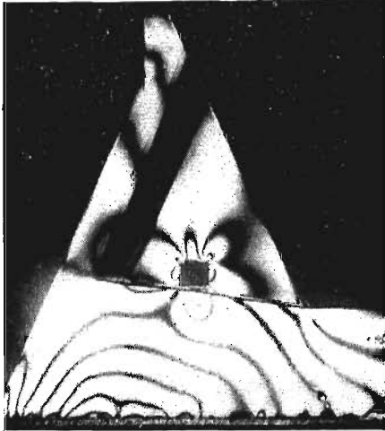
Rys. 2. Izochromy całkowite sekcji nieprzelewowej obciążonej ciężarem własnym
