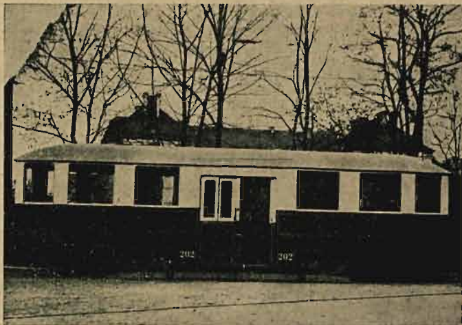
Tramwajowy wagon przyczepny na 57 miejsc, wykonany całkowicie w warsztatach Pozn. Kol. Elektr.
