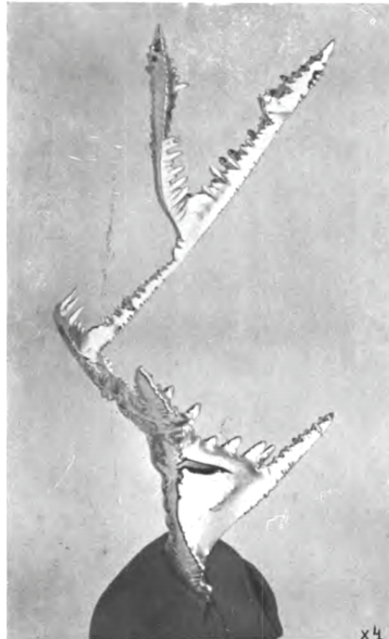
Rys. 4. Dendrytyczny kryształ złota uzyskany metodą Czochralskiego [13]
