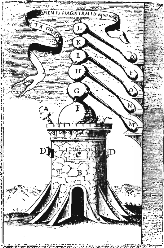
Rys. 5. Aparat destylacyjny z początku XVII wieku umożliwiający odbiór kilku frakcji.
