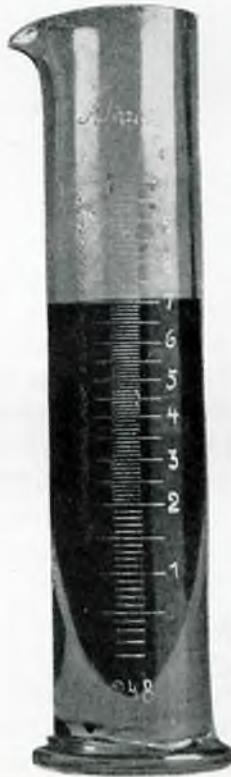
Rys. 15. Miarka szklana do mierzenia ilości opadu.
