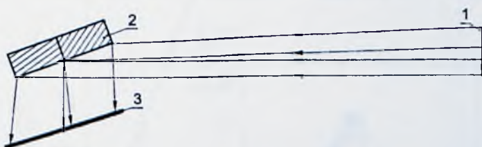
Rys. 10. Schemat biegu promieni X w topografii rentgenowskiej Berga-Barretta. 1 – wiązka rentgenowska. 2 – kryształ. 3 – klisza lub ekran CCD [19]
