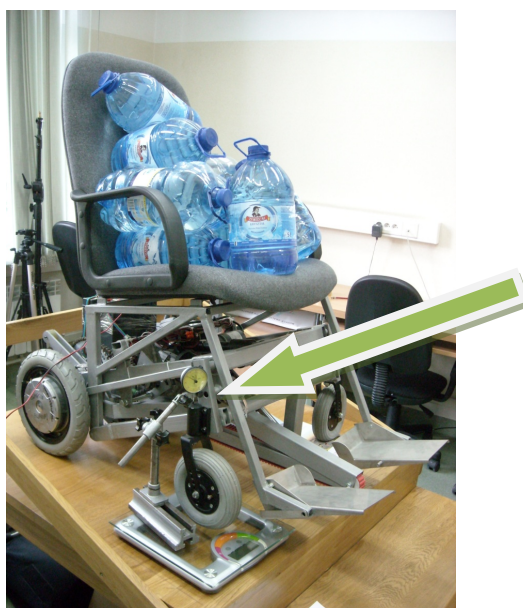
Rys. 43 Stanowisko pomiarowe do wyznaczania charakterystyki siły reakcji podłoża w funkcji ugięcia opony wózka
