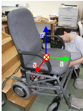
Rys. 61 Lokalizacja i kierunki działania trójosiowego czujnika przyspieszeń
