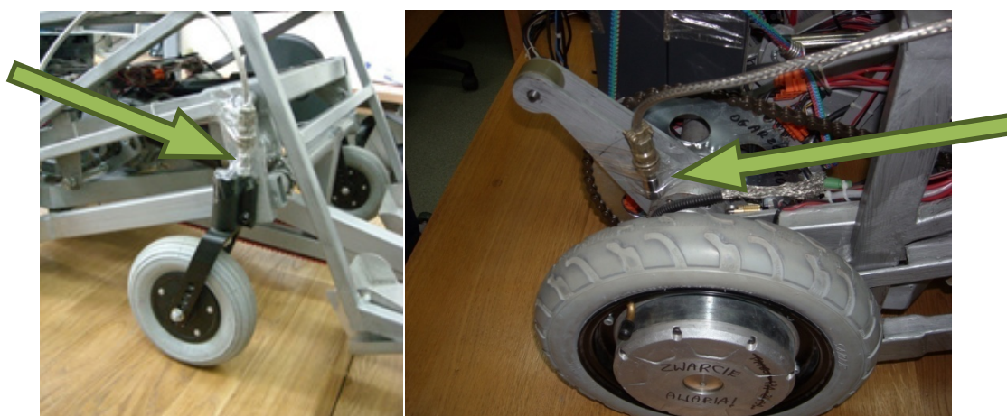
Rys. 45 Rozmieszczenie akcelerometru na ramie wózka
