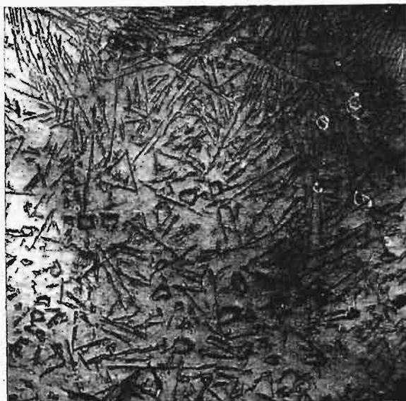
Fot. 4. Brzeg bloczku normalnego stopu odlanego w kokili. Niewytrawiony. Pow. 60X.
