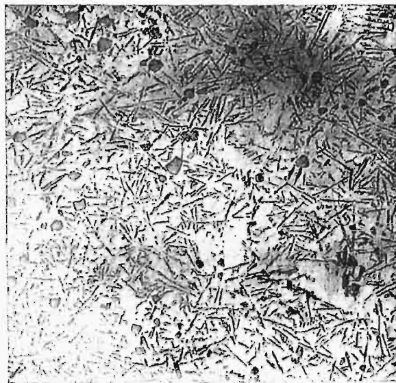
Fot. 2. Normalny stop glin-krzem. Niewytrawiony. Pow. 60X.
