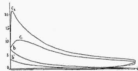
Rys. 31. Wykres silnika czterosuwowego (gaz wodnoczadowy ssany) mocy = 120 k. m.
