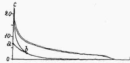
Rys. 21. Wykres silnika dwusuwowego o zawczesnym i prawidłowym zapłonie (ropa naftowa).
