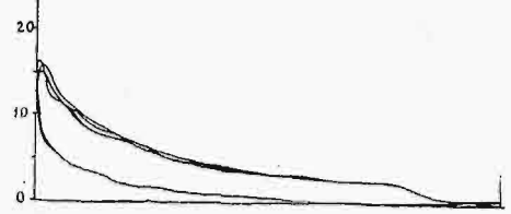
Rys. 20. Wykres silnika dwusuwowego przy luźnym ołówku (ropa naftowa).
